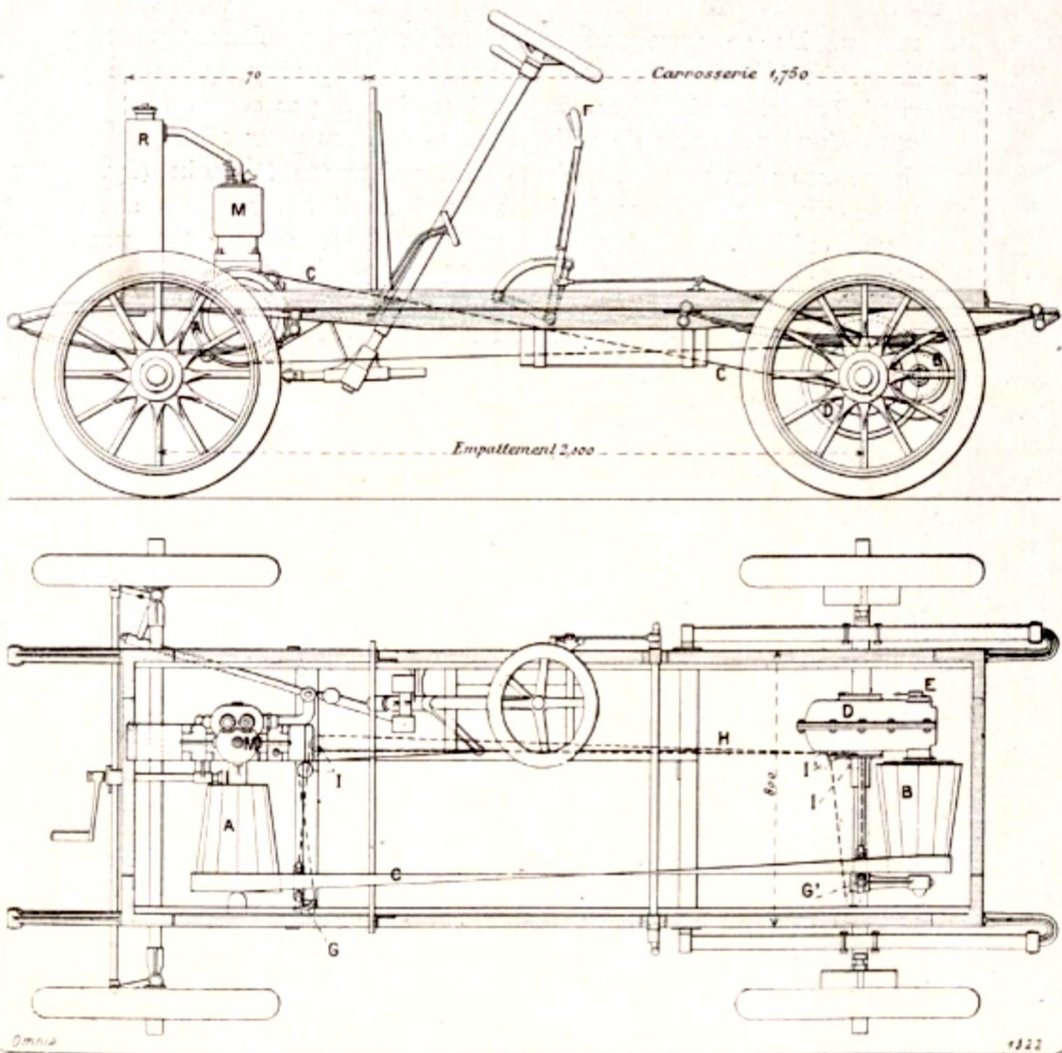
Fig. 3. — VOITURETTE MAHOUT. — A B, poulies coniques en carton comprimé. — C, courroie en cuir de champ. — E, arbre portant le pignon de commande. — D, carter de différentiel. — F, levier de frein. — G G, fourchettes déplaçant la courroie. — H, câbles rendant solidaires les deux fourchettes. — I I, poulies du câble H. — M, moteur. — R, radiateur.
