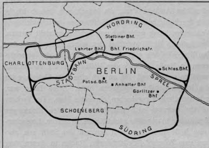
Fig. 7 ANLAGE NACH DEM RADIAL-PERIPHERIESYSTEM.
